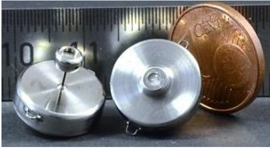
Fig. 8: Finales Design eines verschweißten Drucksensorsystems für venöse Anwendung
