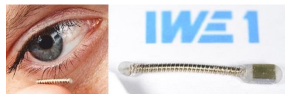
Fig. 2: links: Angestrebte Dimensionen des Sensorsystems; rechts: Demonstrator des Glukosesensorsystems mit in Silikon gegossenen Enden
